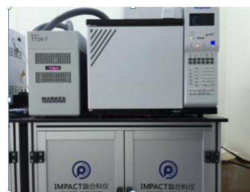
图 4 全在线双冷阱预浓缩 SMART GC 系统
