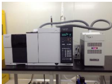
图 3 全在线双冷阱预浓缩 GC-MS+FID 系统
